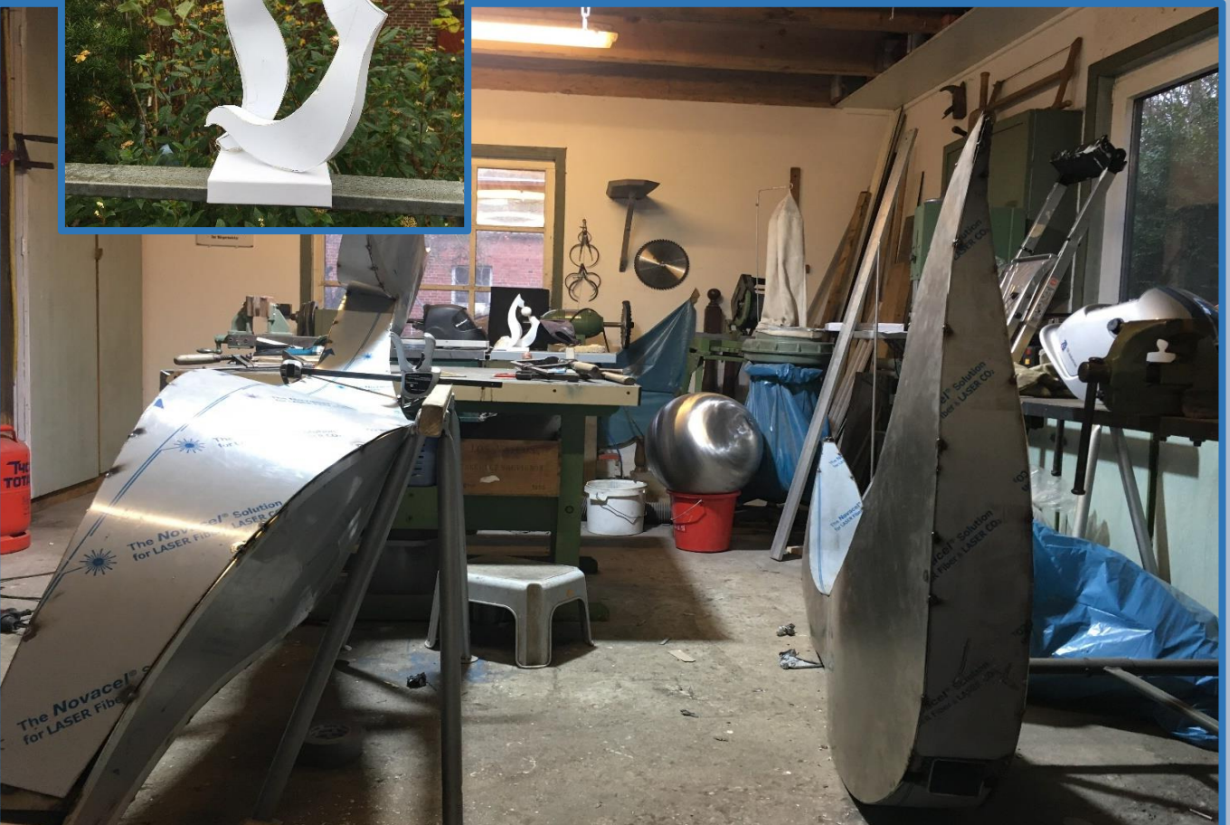
Eine Skulptur entsteht: Modellieren, Schneiden, Formen, Schweißen, Schleifen, Satinieren, Polieren
